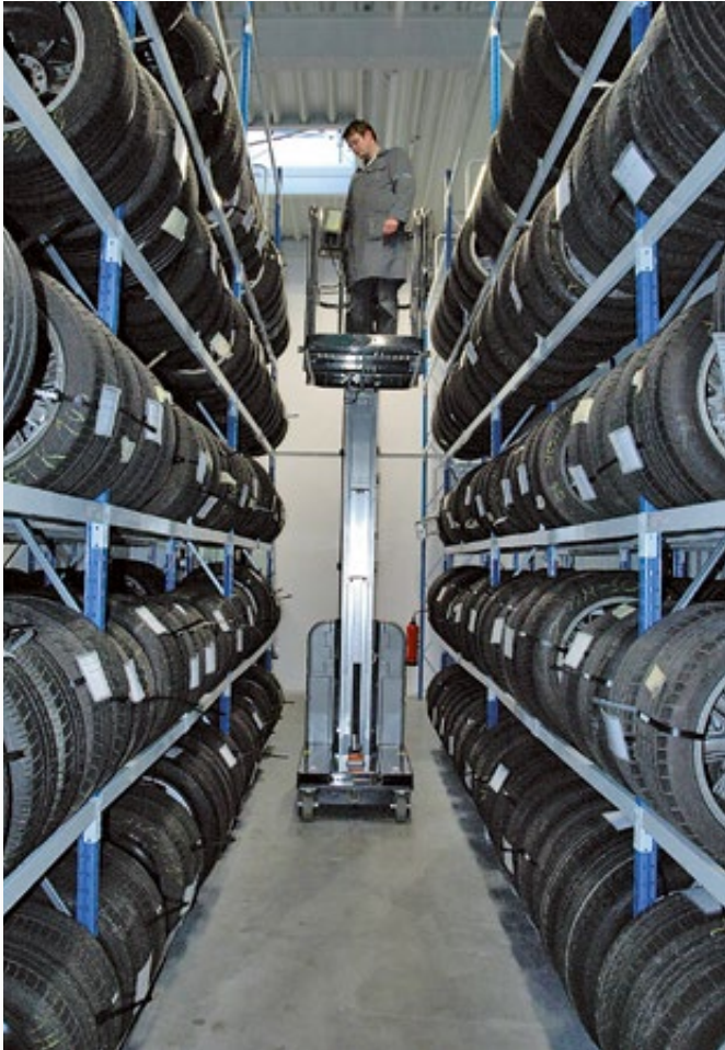
Regalbediengerät für Höhen über 5.000 mm.
