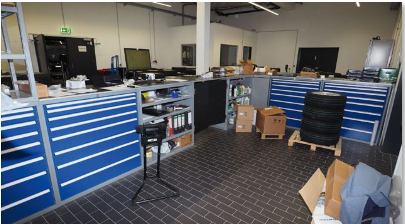
Innenseite: Schubladenschränken zur Lagerung von Kleinstteilen und offene Fächer für Kataloge, Ordner etc.
