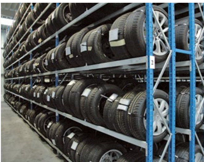
Große Feldweiten erlauben eine optimale Lagerung von unterschiedlichen Reifengrößen.
