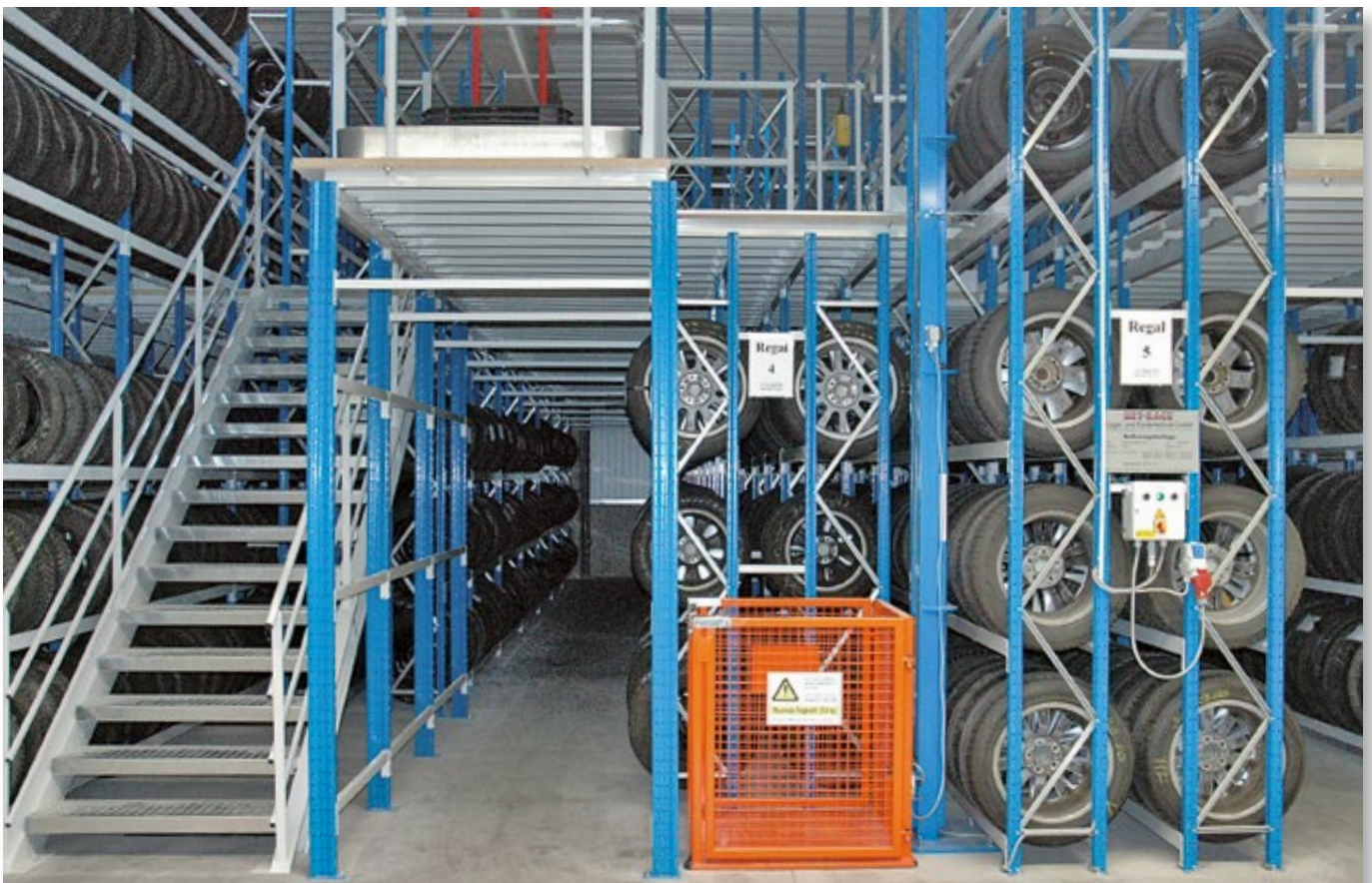
18 Doppelgeschossige Reifenregalanlage mit Reifenlift.
