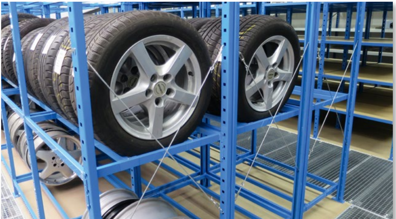
Räderlagerung in speziellen Rohrgestellen.
