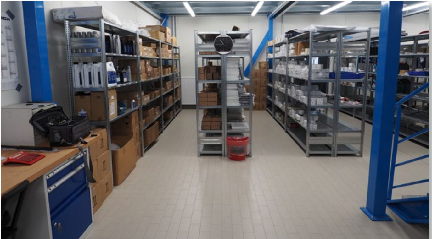
Kleinteilelagerung in Fachbodenregalen unterhalb einer freitragenden Lagerbühne.
