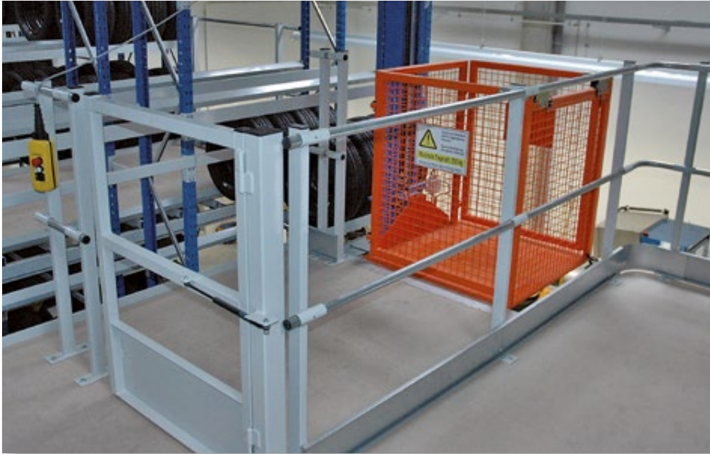
Übergabestation mit Klapptor auf der Lagerbühne.
