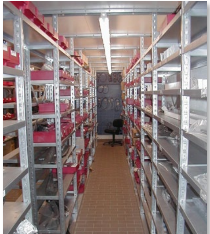
Kleinteilelagerung in Fachbodenregalen unterhalb einer freitragenden Lagerbühne.
