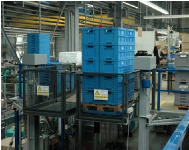
Lastenheber in Doppelfunktion: Heben und Senken parallel möglich.
