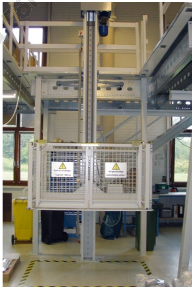
Hubhöhe 4.300 mm, Förderkorb 2.600x 1.500 mm bei einer Möbelspedition.
