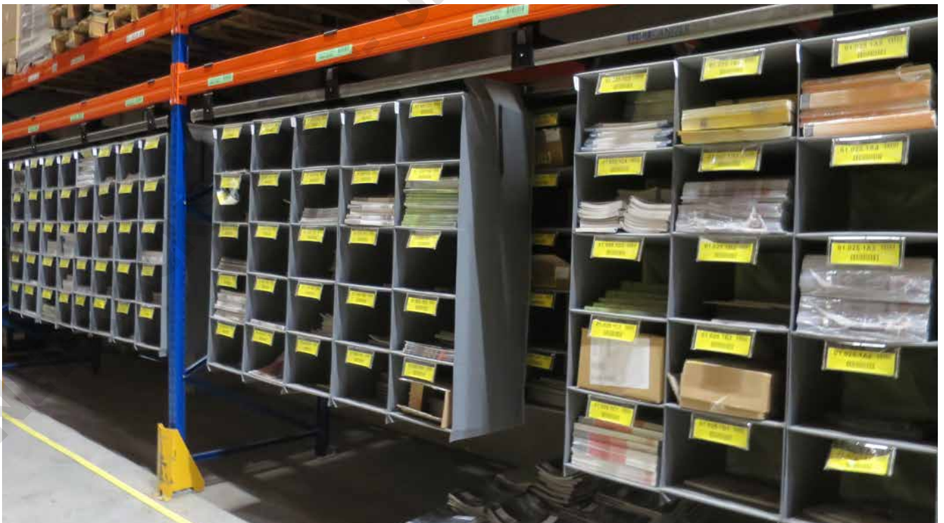
4 8 Säulen mit je 5 Taschen und 2 Reihen in der Tiefe. Zusätzliche Bodenlagerung möglich.
