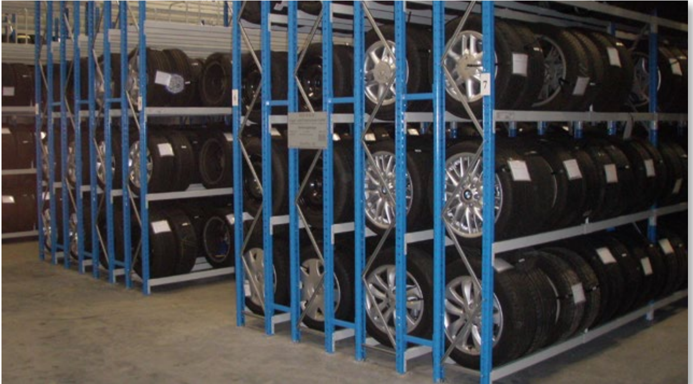
Platzsparende Lagerung der Kundenreifen durch doppeltiefe Regale.
