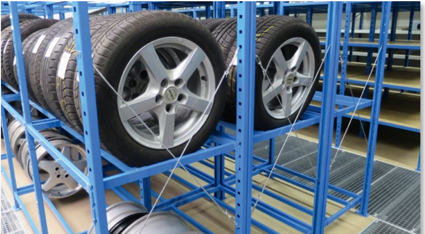
Räderlagerung in speziellen Rohrgestellen.
