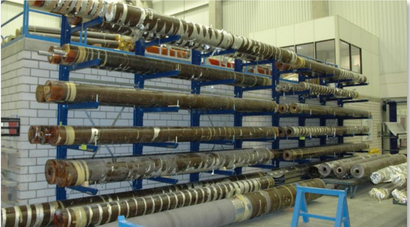
Einseitiges Kragarmregal für Langgutlagerung bzw. Schwerlastlagerung.
