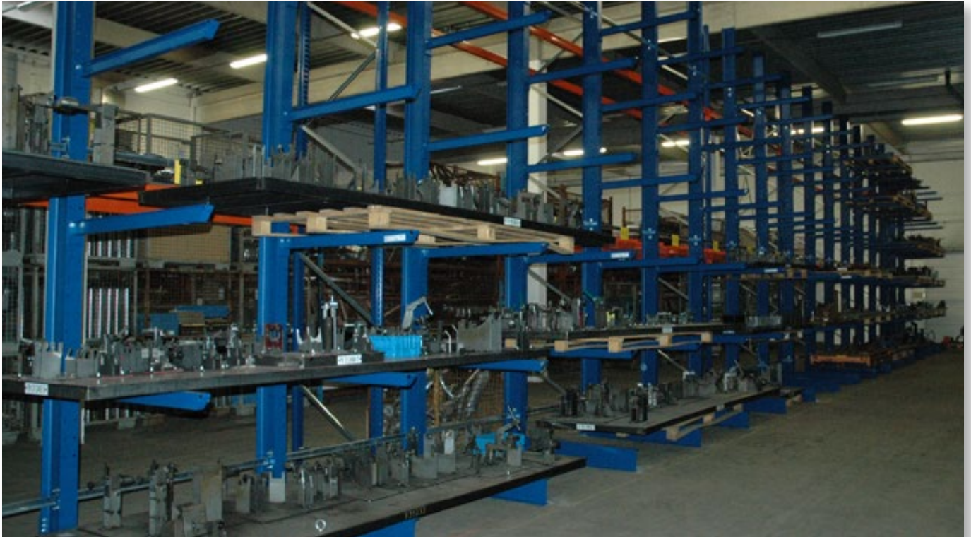
Einseitiges Kragarmregal in einer Halle.
