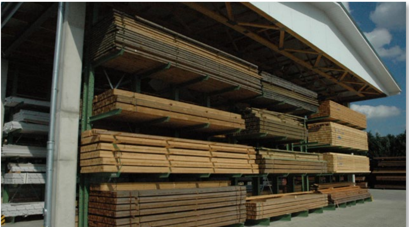
6 Doppelseitiges Kragarmregal für Holzlagerung unter Überdachung.
