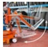
Reifenlagersystem mit Doppelverstellung (Hub/Neigung)
